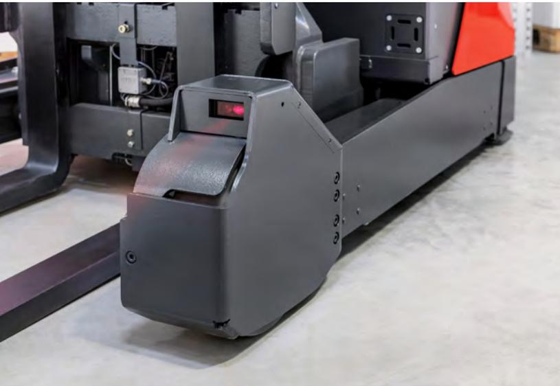
**Präzisionsarbeit** Die Sensoren des Linde RPS arbeiten mit speziellem Polarisationslicht. Es zeichnet sich auch bei schwierigen Sichtverhältnissen durch eine extrem hohe Präzision aus.
